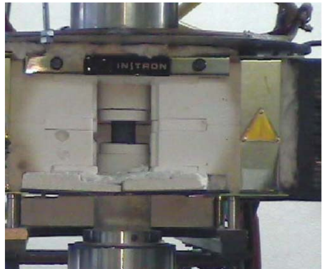
Figura Nº 2: Horno corto de dos zonas para ensayar materiales refractarios en compresión hasta 1600 °C.
