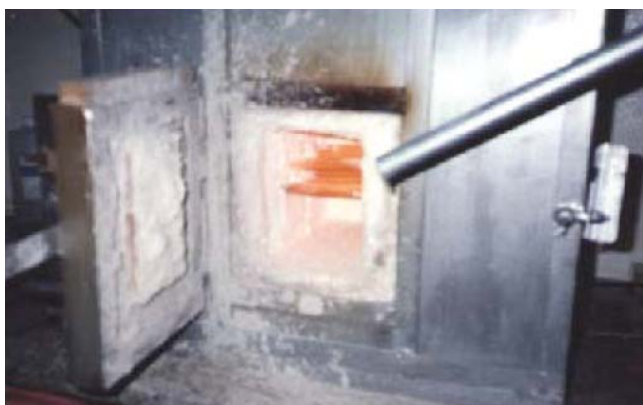
Figura Nº 4: Ensayo de adhesión en caliente (panel y lanza).
