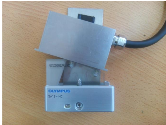
Figura 14: Montaje realizado para adaptar la zapata al transductor.
