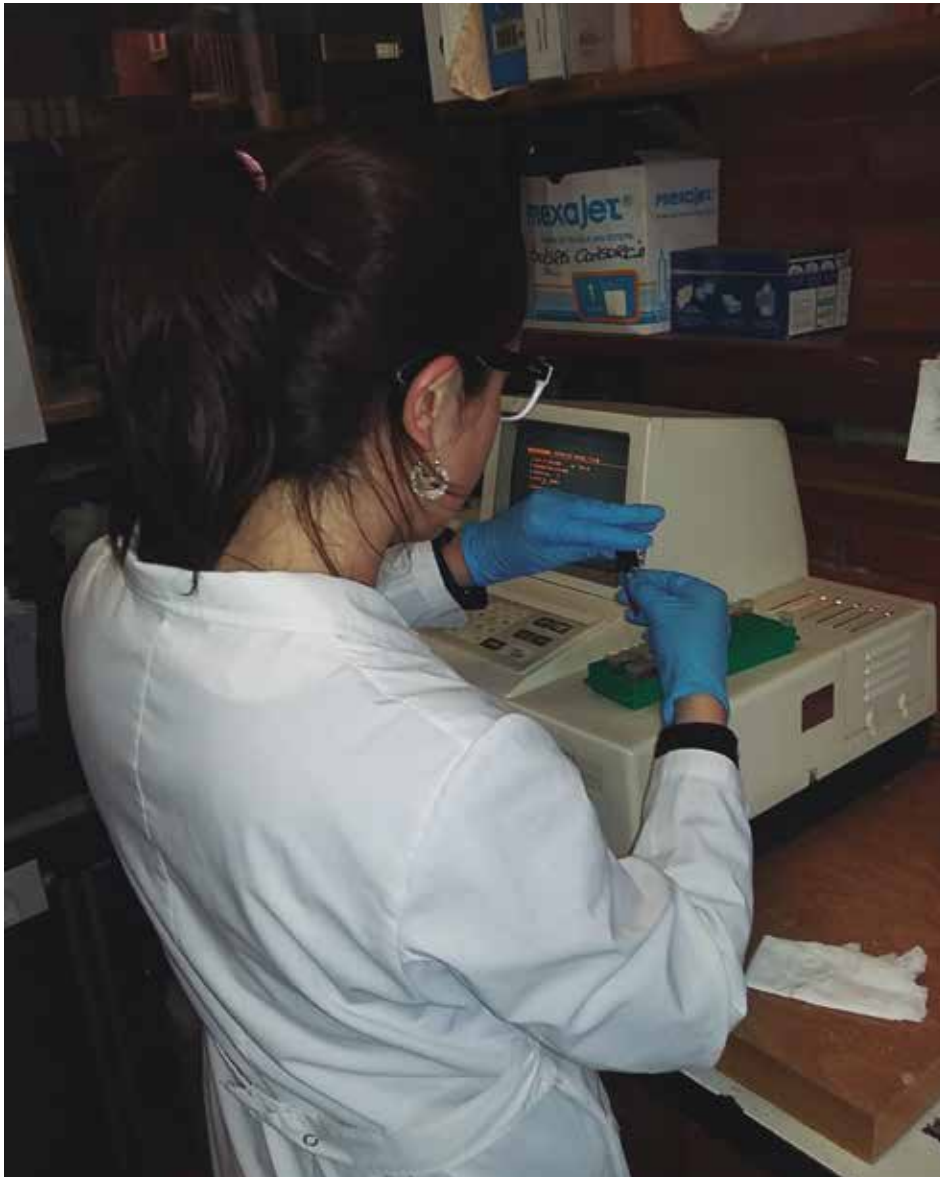
Espectrofotómetro. El monitoreo químico evalúa la presencia de contaminante en el agua y en los organismos acuáticos.
