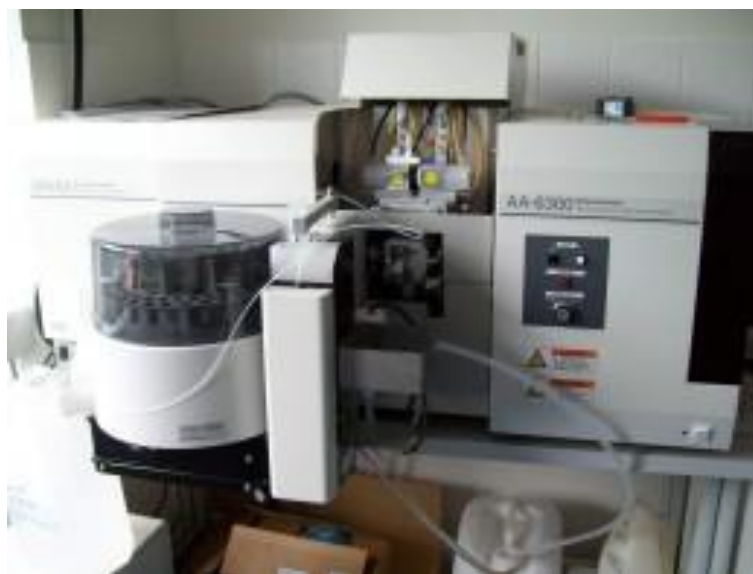
Figura 3.4. Espectrofotómetro de absorción atómica Shimadzu 6600.
