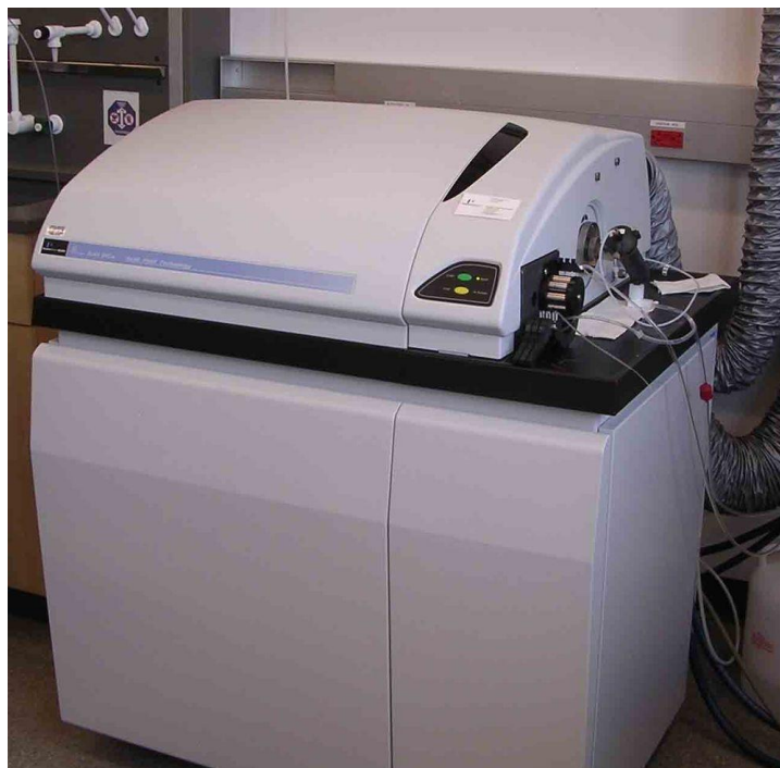
Figura 3.5. ICP-MS empleado en la determinación de minerales.
