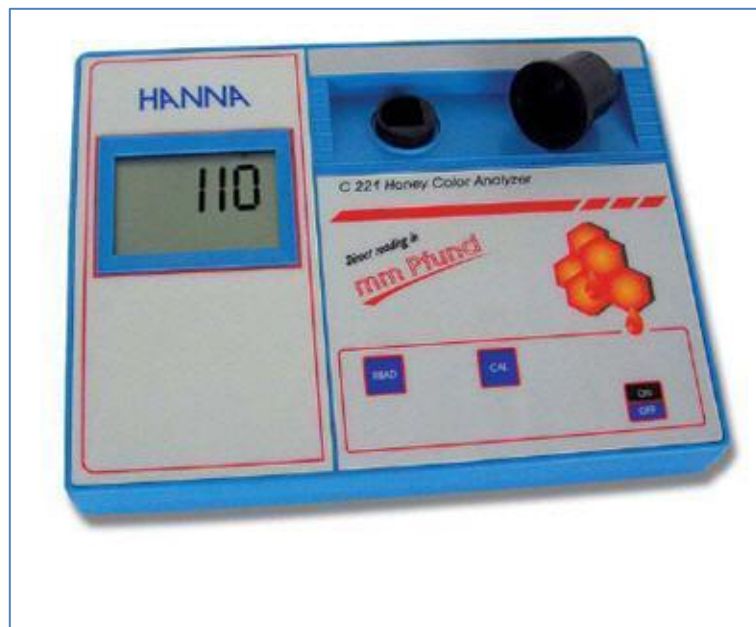
Figura 3.3. Colorímetro HANNA utilizado para medir color en miel
