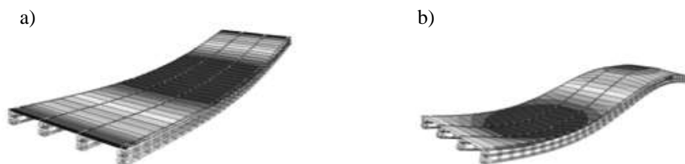
Figura 7: Formas modales entrepiso de luz l_{x1} = 4,8 \text{ m} asociadas a las frecuencias:
