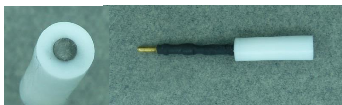
Figura 3.1. Esquema del electrodo de bismuto sólido fabricado en el laboratorio a) e imagen fotográfica de su superficie y cuerpo b)
