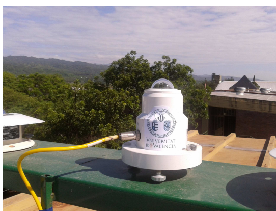
Figura 2. Fotografía del radiómetro Kipp & Zonen UVS-E-T instalado en la terraza del edificio de Física en la Facultad de Ciencias Exactas (Universidad Nacional de Salta).
