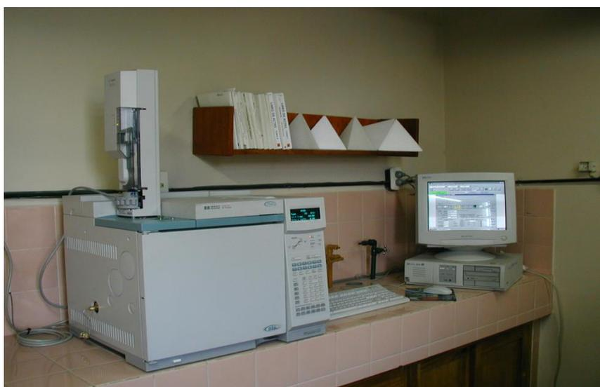
Figura.5.2. Vista de conjunto del sistema cromatografico, mostrando el cromatógrafo en fase gaseosa HP6890, la torreta del inyector automático y la ChemStation acoplada.
