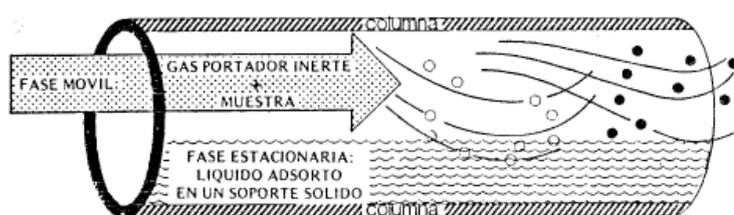
Figura 5.3. Representación esquemática de la columna cromatográfica
