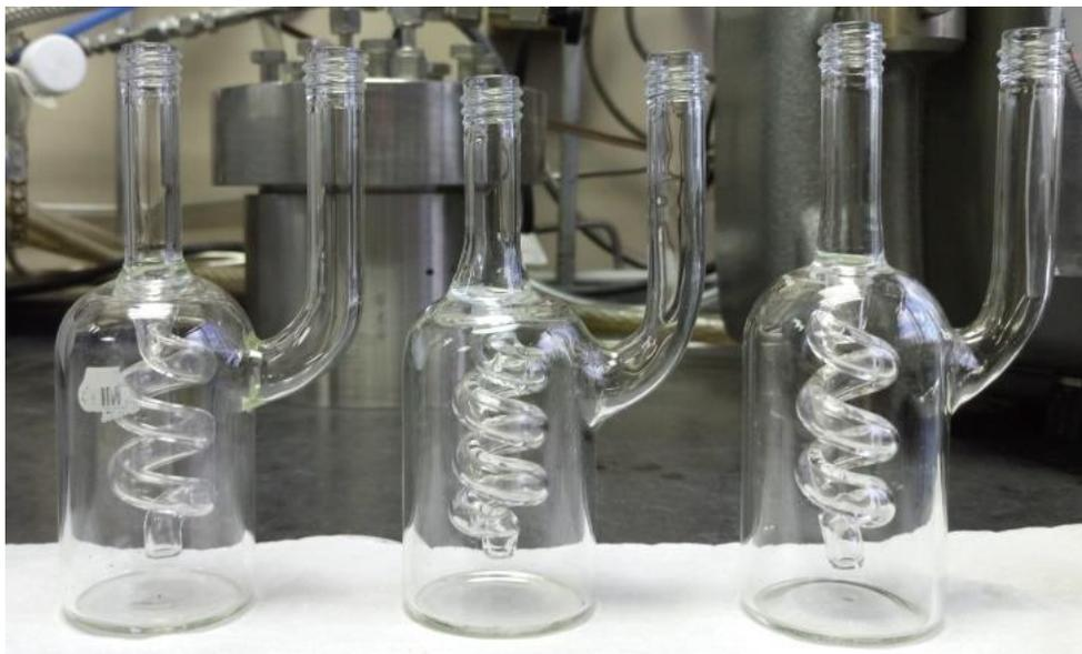
Figura 10.7. Celdas de extracción
