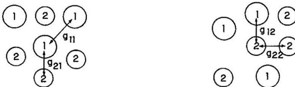
Figura 6.3. Dos tipos de celdas acorde a la teoría de Scott de dos líquidos para mezclas binarias.
