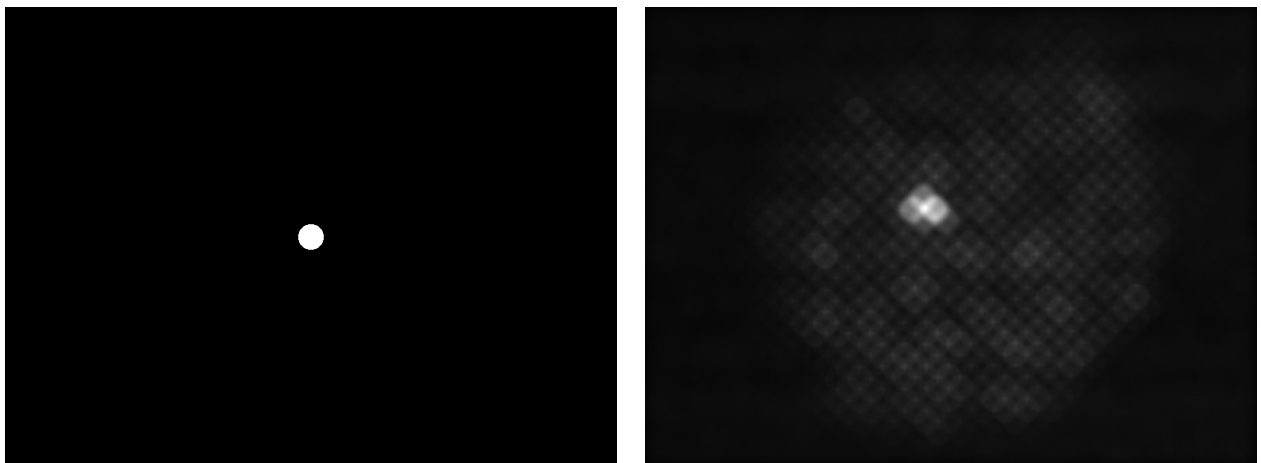
Fig. 4.4. Izquierda: máscara utilizada para el primer filtrado. El diámetro del círculo es de 200\ \mu\text{m} . Derecha: resultante de la convolución entre la imagen promediada sin el fondo y la máscara.
