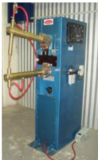
Figura 2: Equipamiento empleado para la soldadura de las chapas de acero DP 1000
