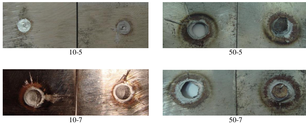
Figura 15: Fotografías con los diferentes modos de fractura del ensayo de shear test
