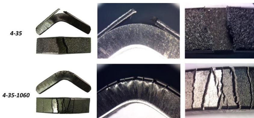
Figura 9: Ensayo de plegado realizado sobre probetas as spray y refundida a 1060°C.
