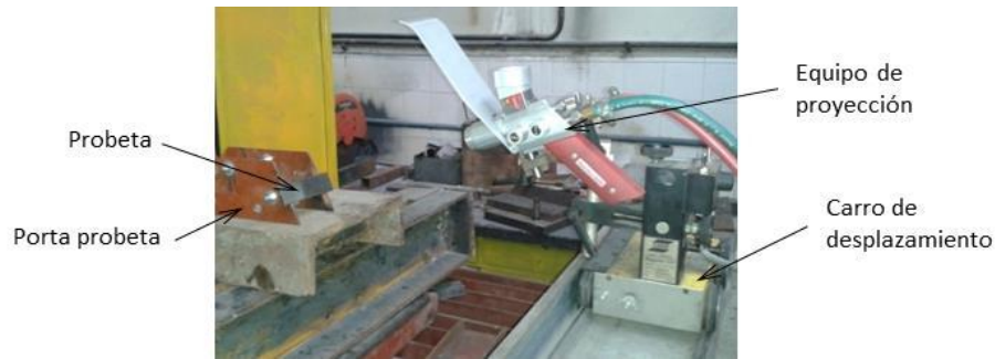
Figura 1: Dispositivos y equipos utilizados para la aplicación del recubrimiento.
