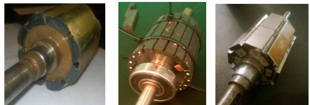
Figura 4. Rotores construidos. Original (a), Rotor 1 (b) y Rotor 2 (c).
