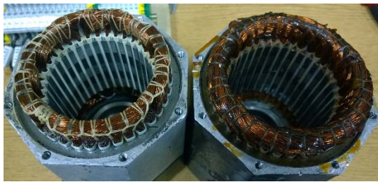
Figura 12. Construcción de los bobinados.
