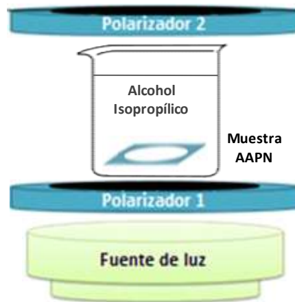
Figura 3.21. Esquema del experimento para determinar la presencia de tensiones anisótropas macroscópicas que contribuyan a la birrefringencia observada en membranas de AAPN. Se ubica la muestra entre los polarizadores que se encuentran cruzados y se compara lo que ocurre cuando la membrana se encuentra al aire y sumergida en alcohol isopropílico.
