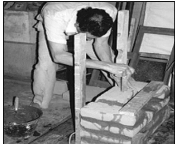
**Foto 9.** Ejecución de una “probeta” de mampostería.
