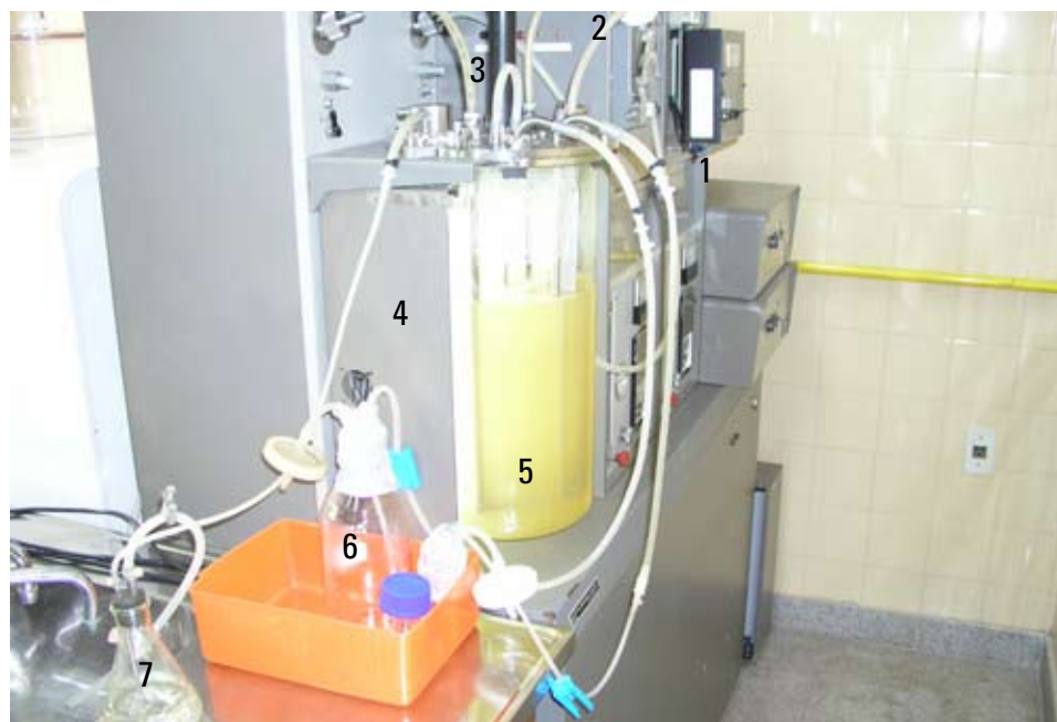
Figura 4: Fotografía de un fotobiorreactor de laboratorio, empleado para el crecimiento de microorganismos fotosintéticos, como las microalgas. Las referencias numéricas corresponden a: 1) sistema de control del fotobiorreactor (agitación, iluminación, etc.); 2) filtro esterilizante en la línea de ingreso de gases; 3) eje del agitador del vaso; 4) panel hemisférico de iluminación, constituido por 12 tubos fluorescentes de 15 W; 5) vaso del biorreactor, en el cual se desarrolla el cultivo del microorganismo en condiciones controladas; 6) frascos para la inoculación, toma de muestras, agregado de sustancias, etc.; 7) frasco lavador de gases provenientes del cultivo.
