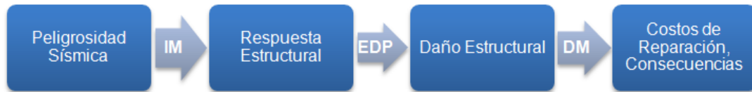
Figura 2.3. Esquema de la metodología de análisis de riesgo sísmico basada en el desempeño
