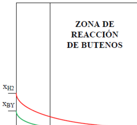
Figura 4.12 - Perfiles de composición para el BY y el H_2 dentro del espesor de capa activa con el BY como reactivo limitante
