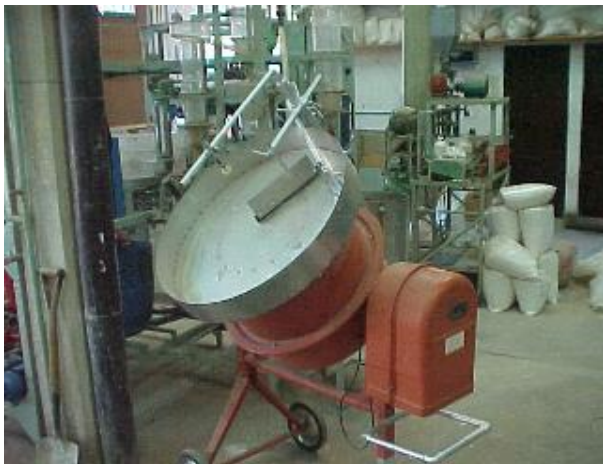
Figura 1. Peletizador de disco escala planta piloto ( D = 77,5 cm)
