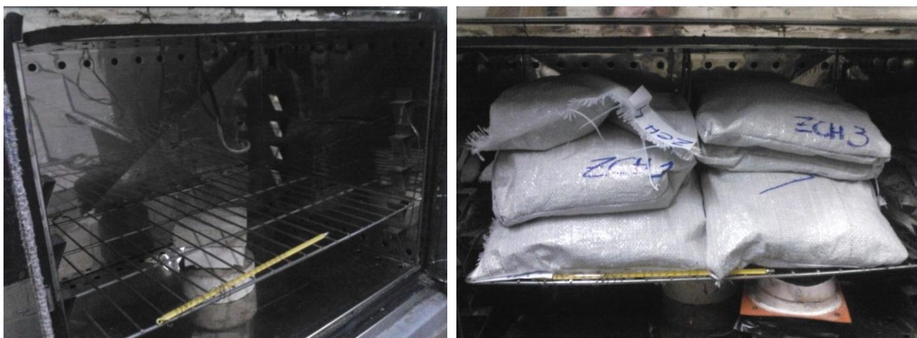
Figura III-8: Imagen del interior de la cámara de estacionamiento acelerado vacía y en proceso de carga de las muestras (12-15 bolsas de 1kg. aproximadamente).
