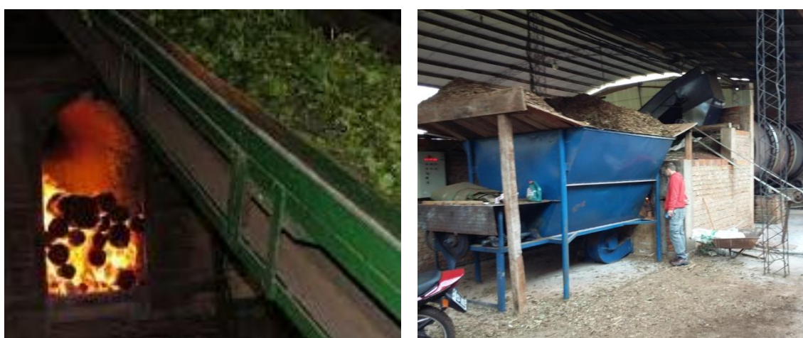
Figura II-11. Comparativo de sistemas de quemadores utilizados (Izq.) Hornos a leña (Der.) Quemadores que utilizan chip de madera.
