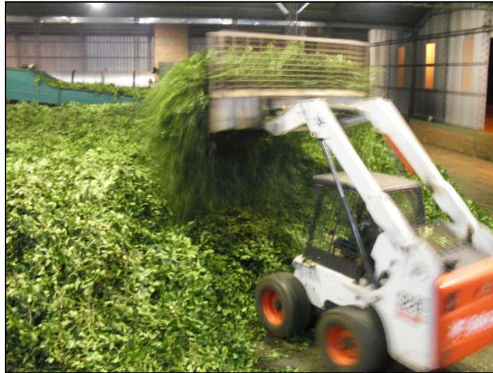
Figura II-3. Alimentación mecánica a la cinta transportadora del zapecador.
