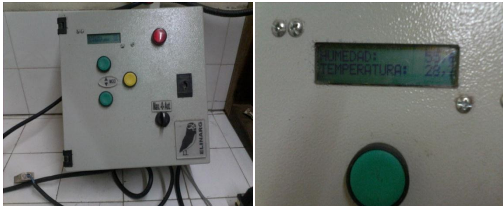
Figura III-5: Imagen del controlador de humedad y temperatura utilizado en la cámara de estacionamiento.
