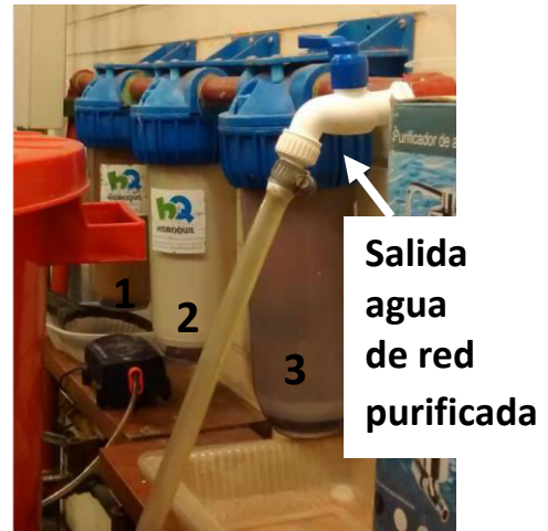
Figura 43. Dispositivo instalado en el laboratorio, utilizado para la purificación del agua de red.
