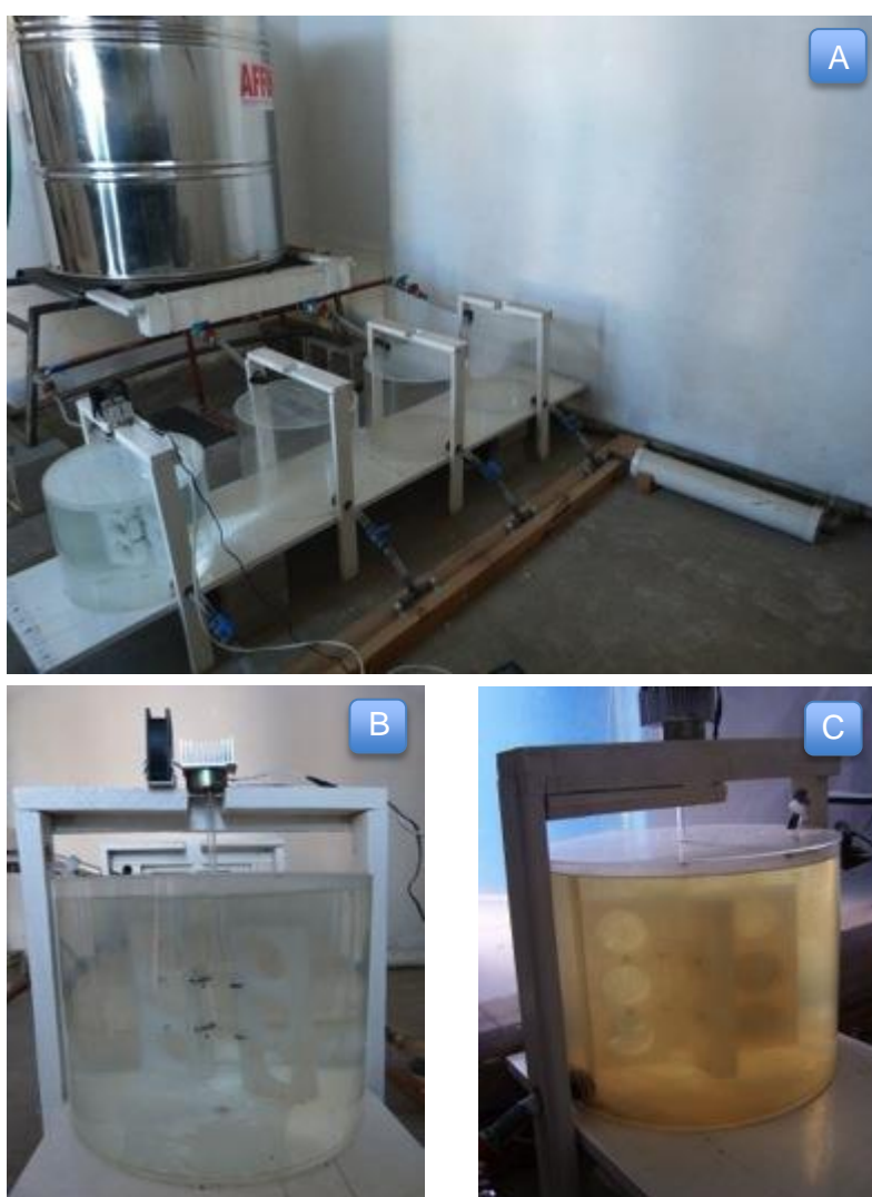
Figura 20. Modelo de calibración de flujo continuo (A) con agua destilada (B) y del Río de la Plata (C).
