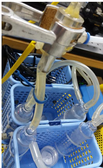
Figura 3. Dispositivo de generación de plasma dispuesto a 4 mm de distancia de dos frascos borbotadores con la solución oxidante de KI y conectados a una bomba de aspiración.
