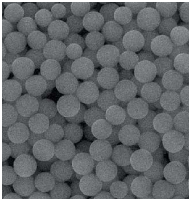
Figura 3. Imagen de nanopartículas de ceria ( \text{CeO}_2 ) utilizadas como catalizadores para eliminar monóxido de carbono de celdas de combustible de hidrógeno. Miden 200nm de diámetro. Foto Matías Jobbágy obtenida por microscopía de barrido electrónico
