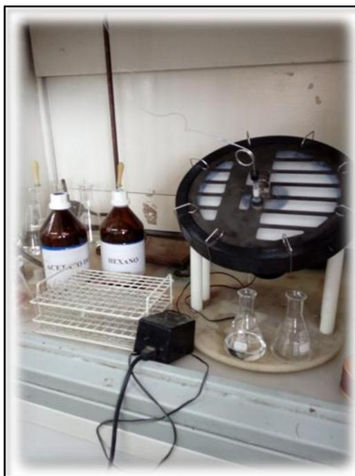
Figura 27: Cromatografía centrífuga radial
