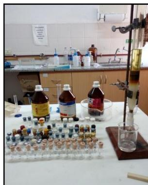
Figura 24: Columna cromatográfica
