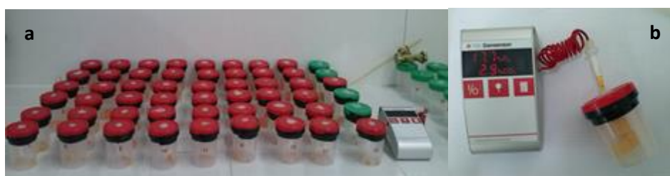
Figura I.2: Muestras de anco frescas y osmotizadas confinadas en recipientes herméticos (a) y medición de \text{CO}_2 generado con analizador de gases portátil (b).
