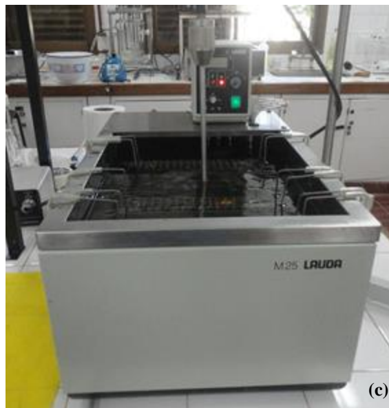
Figura I.1: Cubos de anco en canasta metálica (a) sumergidos en solución osmodeshidratante (b) en baño termostatzado (c).
