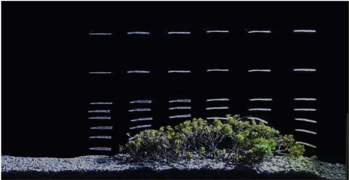
Figura 34. Visualización del flujo a través de la planta pulvinada
