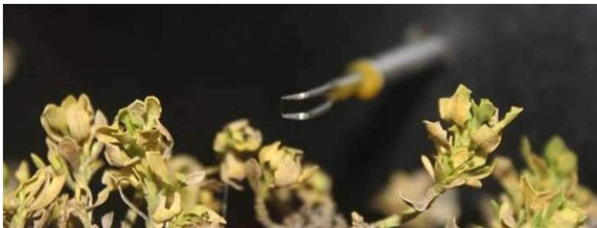
Figura 32. Anemómetro de hilo caliente registrando la velocidad del viento en B. tola ssp tola . Nótese la disposición vertical del alambre
