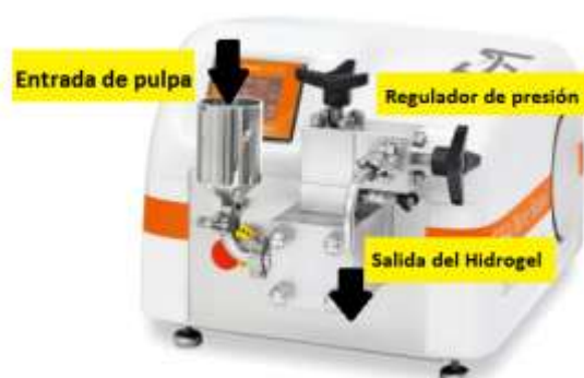
FIGURA 3.4 HOMOGENEIZADOR GEA NIRO SOAVI PLUS 2000
