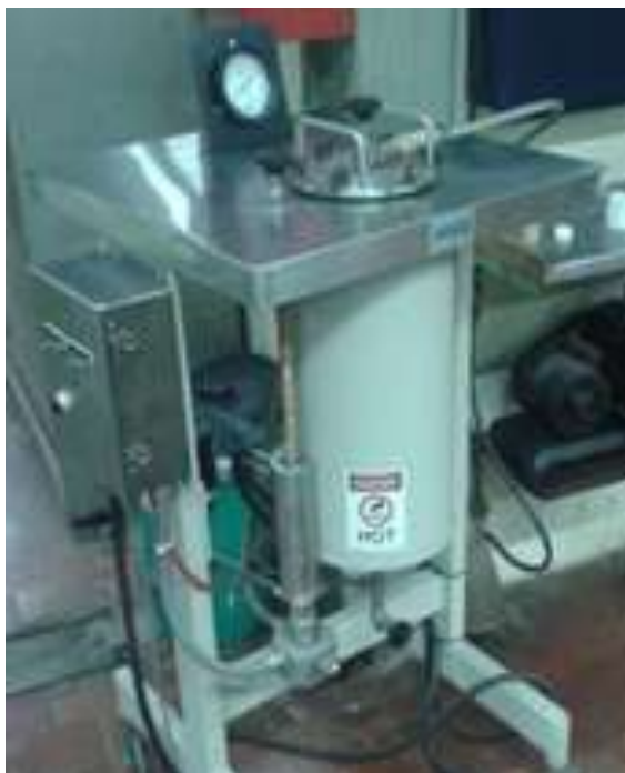
FIGURA 3.1 REACTOR DE COCCIÓN 7 L DE CAPACIDAD
