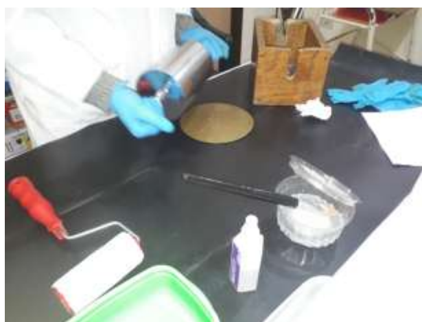
FIGURA 3.11 APLICACIÓN SUPERFICIAL DE 100% DE LNFC SOBRE PAPELES SIN ENCOLAR
