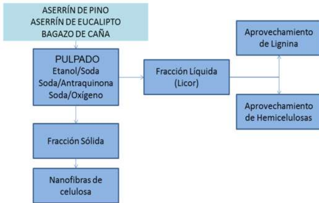
FIGURA 1.27 ESQUEMA DE BIORREFINERÍA PARA PRODUCCIÓN DE NFC
