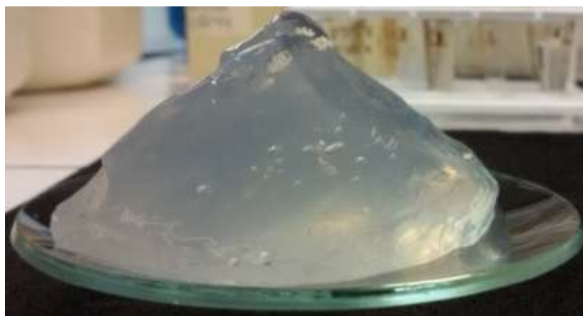
FIGURA 4.13 HIDROGEL DE LNFC OBTENIDO UTILIZANDO UN MIXER DE ALTA VELOCIDAD A 35.000 RPM Y 18 MIN
