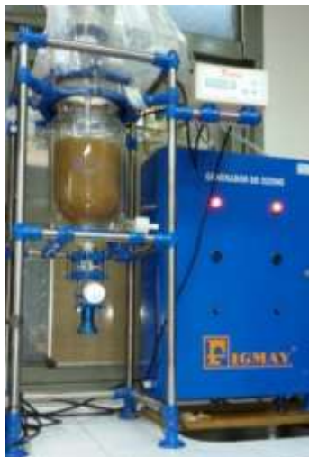
FIGURA 3.2 REACTOR DE OZONO
