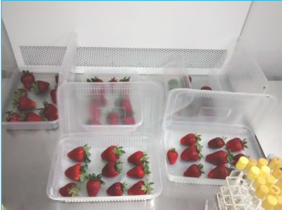
**Figura 3.9.** Frutillas inoculadas dentro de la cabina de flujo laminar.
