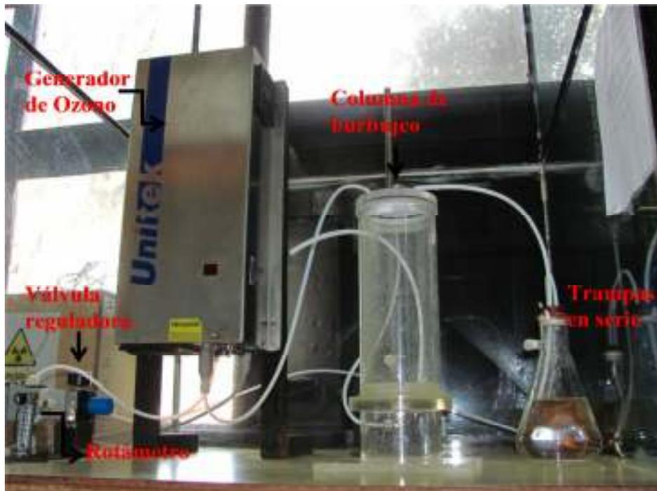
**Figura 3.3.** Configuración del equipamiento para la ozonización de frutillas.
