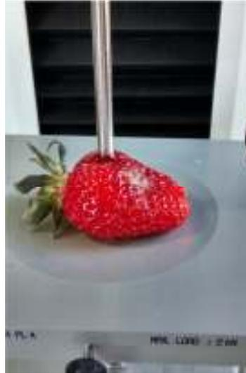
**Figura 3.10.**Ensayo de punción de frutillas.
