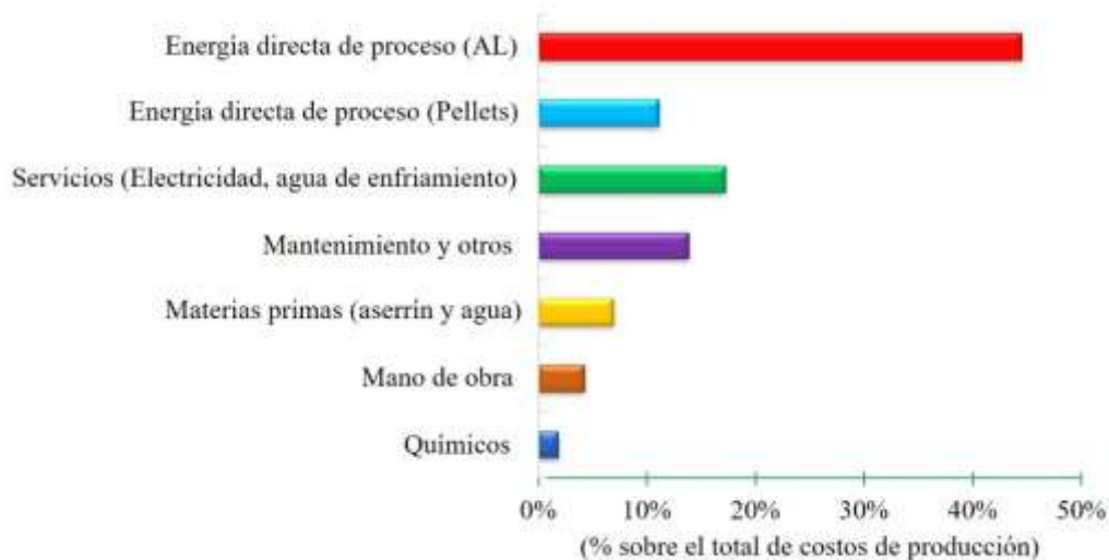
Figura 4.16. Costos de producción en la producción del ácido levulínico y pellets (Alternativa I).
