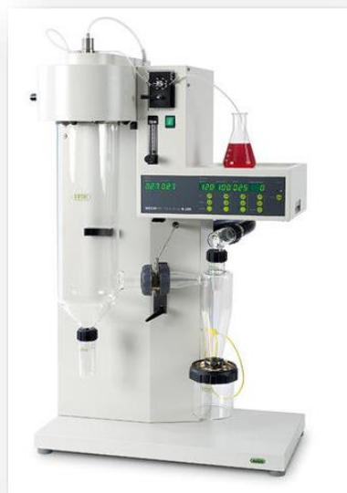
**Figura 41.** Mini spray dryer B-290 (BÜCHI Labortechnik AG, Suiza).
