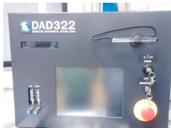
Figura 5.14: Máquina utilizada para realizar los cortes diagonales de 20\mu\text{m} de ancho al wafer de silicio de 0.5\mu\text{m} de espesor.
