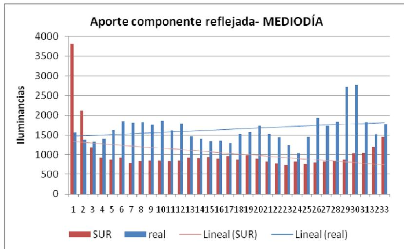
Fig. 12: Barras comparativas de Iluminancias con y sin presencia de fachada captora para 20m.
