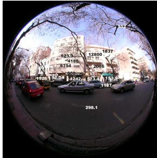
Fig. 10: Luminancias para la Fachada Sur CVU 20m.
