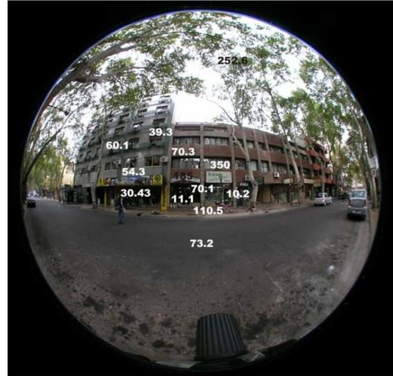
Fig. 13: Luminancias para la Fachada Sur CVU 16m.
