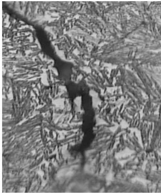
Figura 3. Zona LTF fisurada (1000X)
