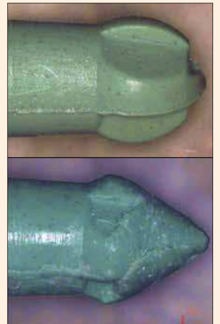
Figura 13. Fresa Smart Burs II round RA-6 fabricada con polímero cerámico y utilizada para la eliminación de tejido cariado a baja velocidad de \pm 5000 rpm. Previo a su utilización y posteriormente a su destrucción al contactar con dentina sana.
