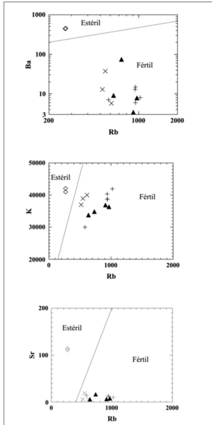
Fig. 10: Diagramas de elementos trazas indicadores de potencial mineralizador
