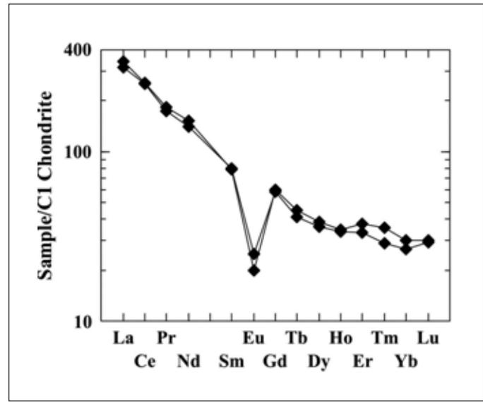
Fig. 15: Diagrama REE normalizado a condrito (Anders y Gravesse, 1989) sin efecto tetrad para la facies porfírica del granito Los Ratones
