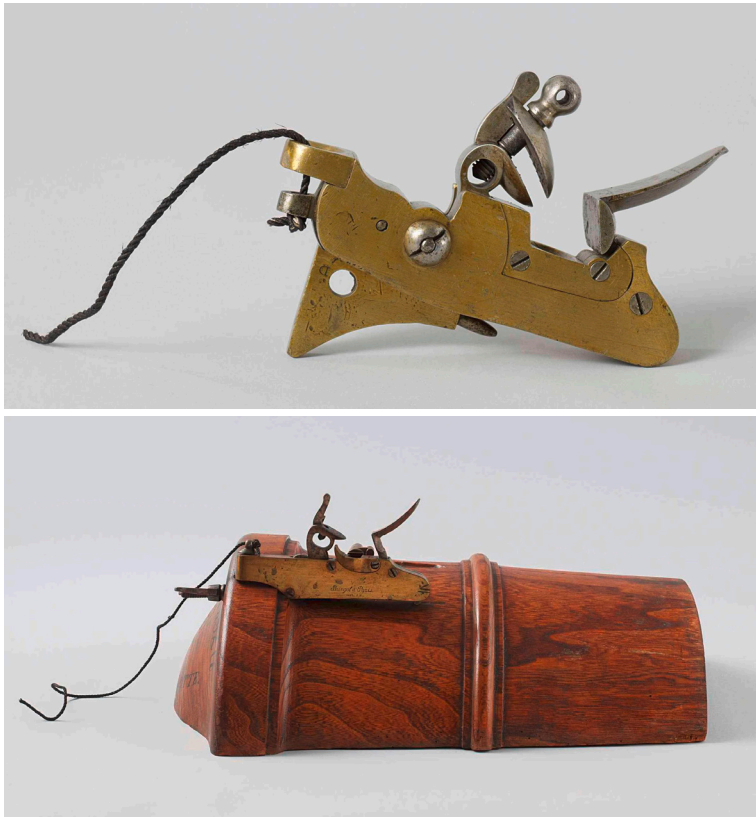
Figura 6. Mecanismo de disparo por medio de llave de chispa: a) pieza de aleación de cobre y hierro de ca. 1800 (NG-MC-692); b) montaje de una llave francesa de principios del siglo XIX, para un cañón de 12 libras (NG-MC-698). Fuente: Rijksmuseum (Museo Nacional de Ámsterdam), Países Bajos.
