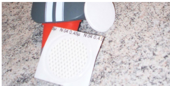
Figura 7. Aspiradora y papeles de filtro. El de arriba es para determinar el peso del residuo aspirado; el de abajo permite determinar los tamaños de las partículas.
