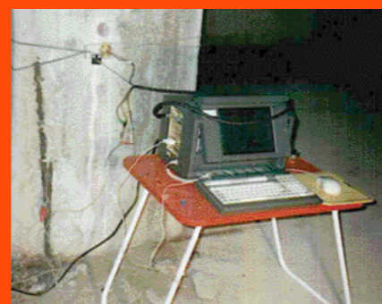
Figura I. Medición de la resistencia a la polarización utilizando un potenciómetro portátil. Esta medición brinda información sobre la velocidad de corrosión de la armadura (ver tabla 1).
