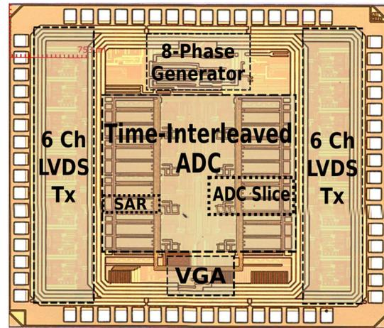
**Fig. 15** Chip die photo. Die size: 3 x 3.5  $\text{mm}^2$
