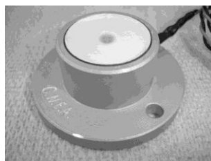
Figura 13 - Solarímetro fotovoltaico desarrollado por el DES.
