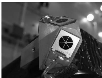
Figura 9 - Sensor de posición integrado al panel de vuelo del SAC-D.
