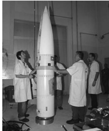
Figura 7 - Cofia del cohete VS-30. Arriba de la faja central se observan dos de los cinco soportes de sensores apareados.
