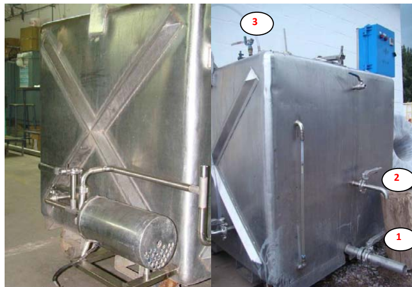
Figura 1. Fotografías del Biodigestor anaeróbico construido a escala piloto (1000 litros).
