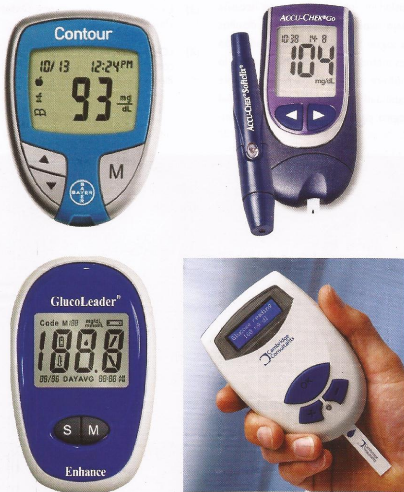
Figura 4. Modernos biosensores para glucosa. Más de 20 patentes y cientos de modelos están basados en similares principios, en general son pequeños potenciostatos de potencial fijo (+400 mV vs Ag/AgCl), con una tira descartable impresa por screen-printing, en una configuración de 2 o tres electrodos, una enzima redóx (usualmente glucosa oxidada), y un mediador redóx (usualmente derivados de ferroceno).
