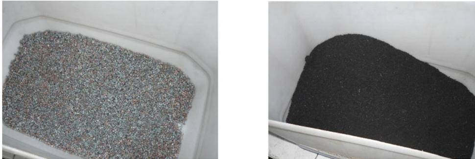
Figura 1: Polietileno de baja densidad triturado y caucho triturado
