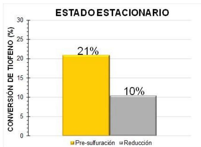
**Figura 3.** Conversión de tiofeno en el estado estacionario, del catalizador  $Ni_2Mo_3N$  sometido a las etapas de activación por presulfuración y por reducción con  $H_2$ .
