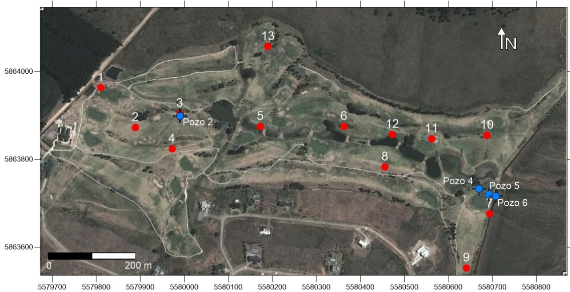
Figura 2. Ubicación de sondeos eléctricos verticales y pozos. Figure 2. Location of vertical electrical soundings and pumping wells.
