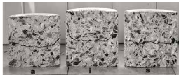
Figura 10. Perfiles de penetración en diferentes superficies de probetas cilíndricas de a/c=0,45 (a=aserrada; i=interna; s=escarificada).
