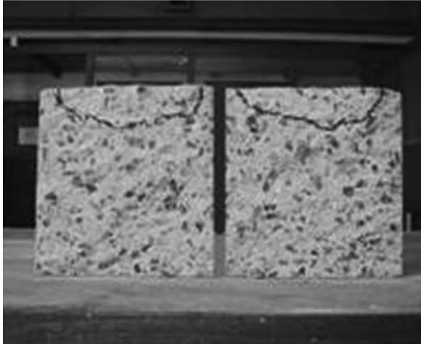
Figura 3. Frentes de penetración de agua.
