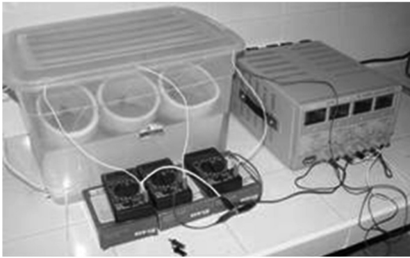
Figura 10. Ensayo de migración de cloruro.
