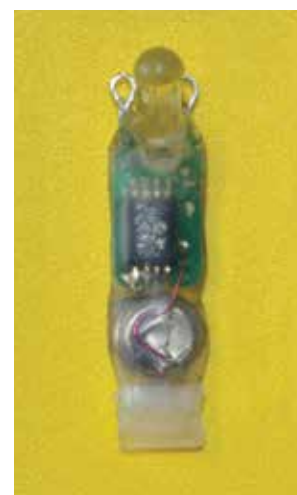
Figura I. Geolocalizador. Mide 2,5cm.
