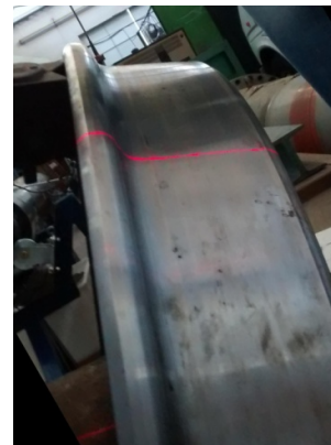
Figura 7. Perfilometría de rueda de tren.
