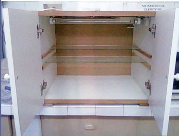
FIGURA 1 - Equipo utilizado para realizar el tratamiento de las carnes con luz UVC. En la parte superior se encuentran lámparas
